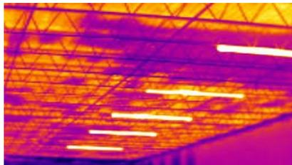
Тепловизионная съемка крыши изнутри помещения для содержания птицы.
